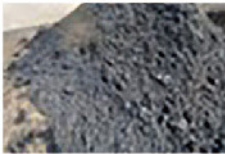
하폐수처리장 슬러지 (함수율 약 70%)
